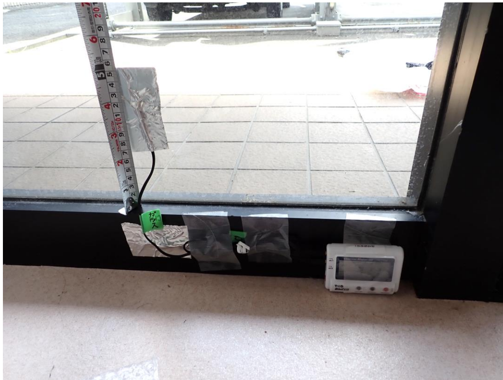
写真 夏期における窓表面温度の実測風景
