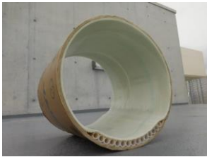
熱交換部の断面モデル▶
